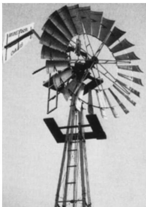
Veterný agregát používaný na čerpanie vody.
