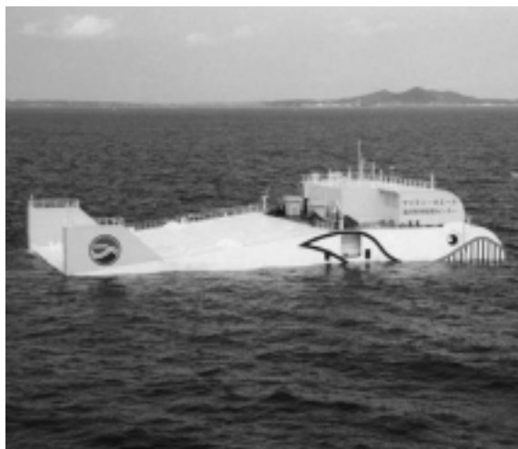
Mighty Whale vyrába elektrickú energiu z morských vln.
