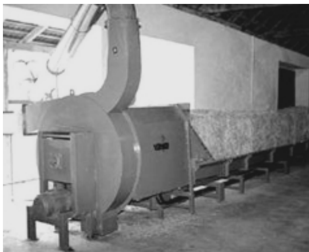
Dopravník a drvič v automatickom zariadení na spaľovanie slamy.
